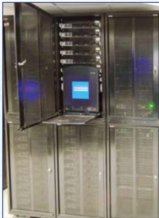
◀ Кластер «СКИФ-ГРИД» (36 вычислительных узлов и 2 управляющих узла): Пиковая производительность кластера без учёта ускорения с помощью графических процессоров составляет 8 Тфлопс. ◀ Cluster «SKIF-GRID» (36 computational nodes and 2 control nodes): Peak performance of the cluster without taking into account the acceleration by graphics processors is 8 Tflops.
