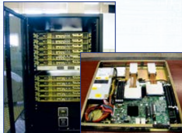
▲ Кластер ПСК-СКИФ (10 вычислительных узлов и 1 управляющий): персональный кластер с системой охлаждения на базе отечественных тепловых трубок. Пиковая производительность не менее 1 Тфлопс. ▲ Cluster PSK-SKIF (10 computational nodes and 1 control node): personal supercomputer with the cooling system on the basis of original heat pipes. Peak performance is no less than 1 Tflops.
